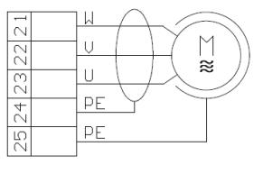
Para un correcto funcionamiento de la central y de las fotocelulas es FUNDAMENTAL conectar la PUESTA A TIERRA a la central de mando y al motor!
