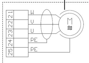
Per un corretto funzionamento della centrale e delle fotocellule è FONDAMENTALE collegare la MESSA A TERRA alla centrale di comando e al motore !
