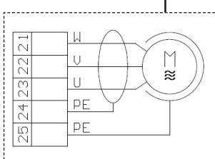
Pour un fonctionnement correct du coffret de commande et de photocellules, il est FONDAMENTAL connecter la MISE A LA TERRE au moteur et au coffret de commande!
