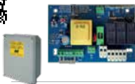
ABJ8042 R-CRX 2.0 tableau pour 1 JOLLY avec récepteur 433 MHz intégré. Avec conteneur IP 55. Voir les Pages 171 et 177
