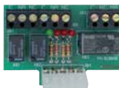
ACQ9081 CARTE 3 RELAIS pour P1 pour gérer une lampe de courtoisie, un feu de signalisation ou un blocage électromagnétique
