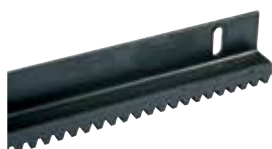
ACS9050 CRÉMAILLÈRE M4 en métal (sect. 22 x 22 mm) peinte avec CATAPHORÈSE, avec cornière 45 x 30 mm (jusqu'à 4.000 Kg) en barres de 2 m au m
