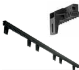
ACS9026 Crémaillère M4 en nylon avec barre interne en acier (sect 28 x 40 mm) Avec 6 fixations vers le bas (jusqu'à 800 Kg). en barres de 1 m au m
