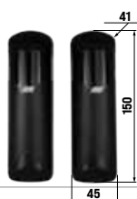
ACG8046 NOVA (no/nf) portée signal infrarouge 15÷40m faisceau infrarouge réglable 180° synchronisme jusqu'à 4 paires IP 44 - 12/24V ac/dc
